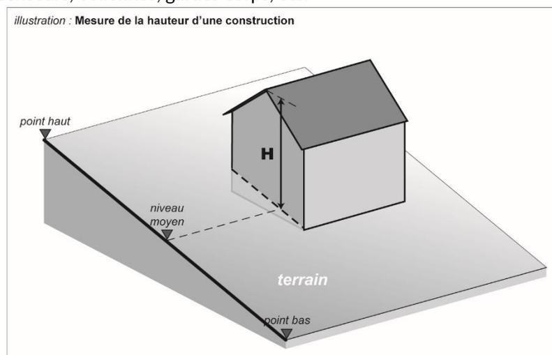
La hauteur des constructions ne doit pas excéder 7 m à l'égout de toiture principale ou à l'acrotère bas de l'attique. En cas de toiture avec attique, la hauteur totale au faitage 12 m ne doit pas excéder 12 mètres.
