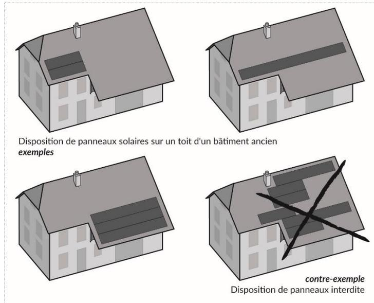
Illustration 22 : Schéma de positionnement de panneaux solaires.
