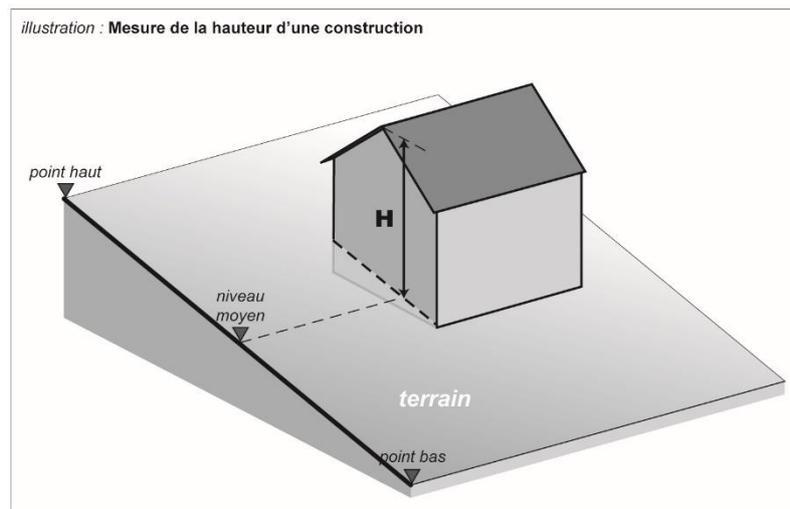
La hauteur des constructions ne doit pas excéder 9 m à l'égout de toiture principal.
