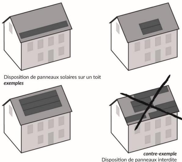
Illustration 38 : Schéma de positionnement de panneaux solaires
