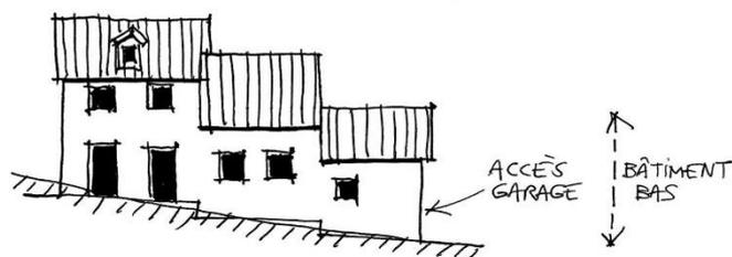
La ligne de faitage ne s'implante pas obligatoirement parallèlement aux courbes de niveaux ; le bâtiment se décroche en plusieurs volumes pour suivre le dénivelé et éviter les volumes trop hauts.
