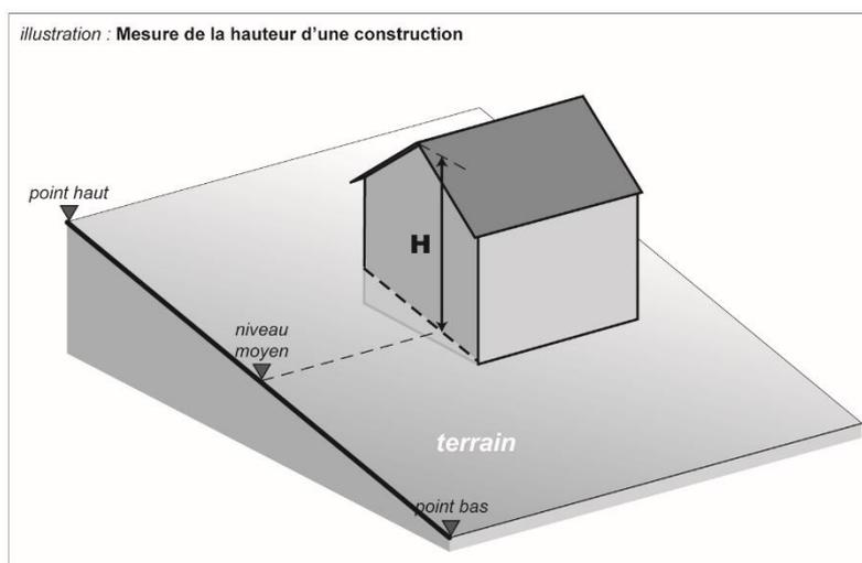
La hauteur des constructions ne doit pas excéder 7 m à l'égout de toiture principal.
