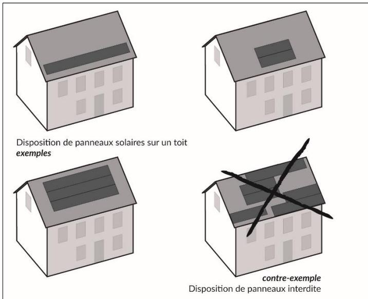
Illustration 30 : Schéma de positionnement de panneaux solaires.
