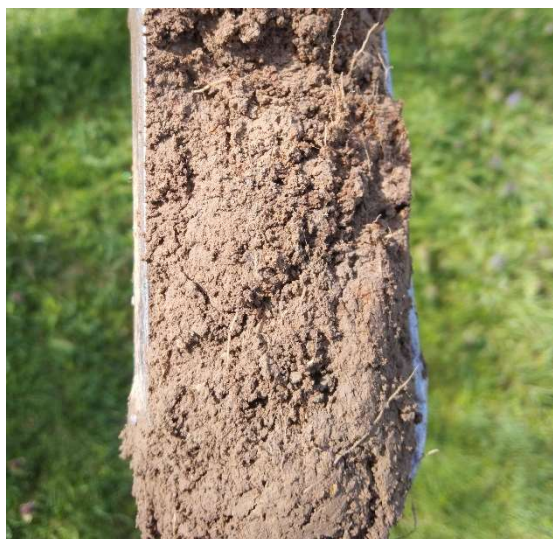
Traits rédoxiques à moins de 25 cm de la surface (sondage n°1)
