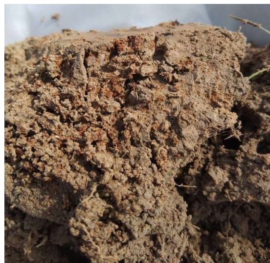
Traits rédoxiques en section d'un carottage à -15/-20 cm (sondage n°1)
