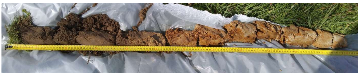
Profil complet caractéristique de la classe GEPPA Vb (sondage n°1)
